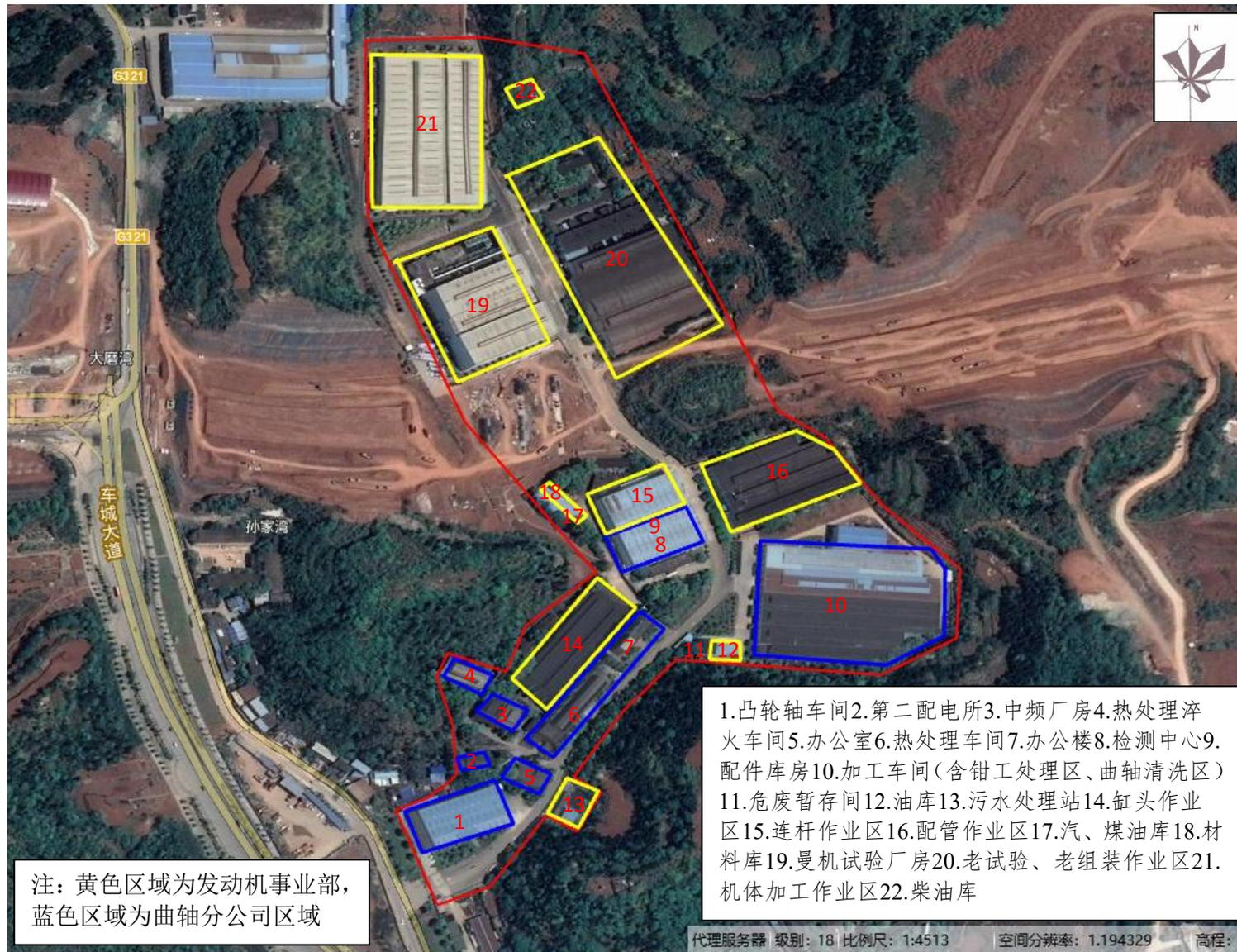
图4.3-1 曲轴分公司、发动机事业部检测中心平面布置图
